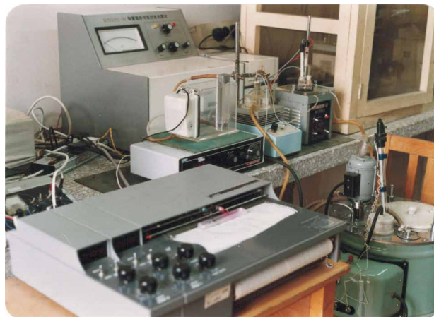
电脑控制电生理信号与分光光度计读数同时读取和记录装置
